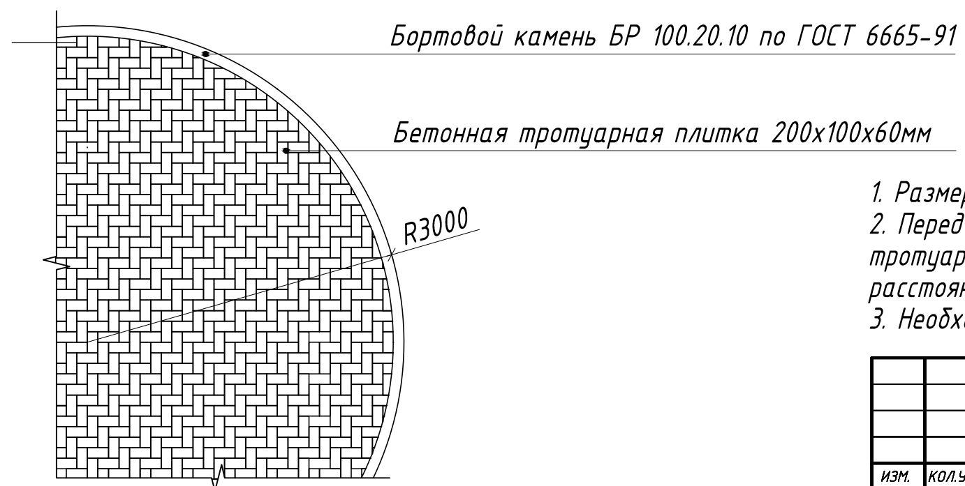
Фрагмент 3 круги - укладка "елочка", красная бетонная тротуарная плитка, 100%
